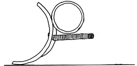
Mittels der mitgelieferten Schraube, welche unter dem Schneefangrohr die beiden Hälften verbindet, werden diese zusammengeschraubt.
