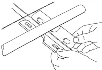
Alle Schneefanglaschen montieren und Schrauben mit einer Ratsche oder Schlagschrauber anziehen. Die Schraube darf nicht mitdrehen, um eine Beschädigung des Falzes zu vermeiden. Anzugsmoment 50 Nm bei Stehfalz-Schneefanglaschen, 25 Nm bei Profil-Schneefanglaschen.
