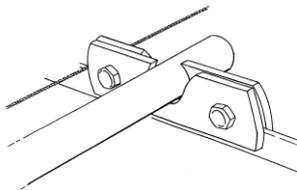
An einer Seite wird das Schneefangrohr eingeführt und jeweils am Ende entlang der Schnur mit einer weiteren Schneefanglasche befestigt. Danach sind ein Rohrverbinder einzustecken und weitere Rohre zu montieren.
