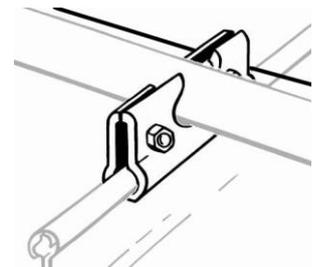
Zur Montage sind die Schneefanglaschen mit der Kröpfung nach innen waagrecht unter das Schneefangrohr zu legen. Anschließend werden diese hochgeklappt und die Schrauben eingesetzt. Schraube festhalten, Mutter anziehen und Schneefanglasche nach dem Schnurschlag ausrichten.
